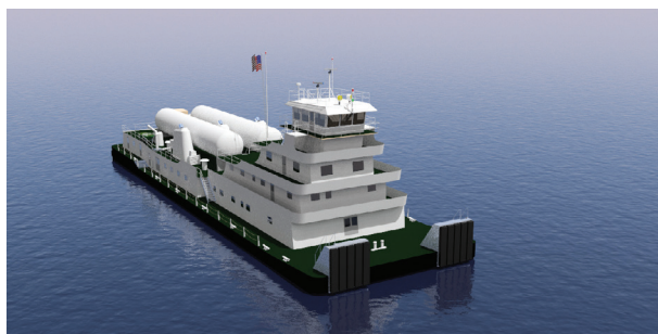
Figure 6. Towboat converted to LNG fuel.
